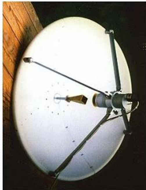
Antena Cassegrain untuk frekuensi 18 sampai 40 GHz
